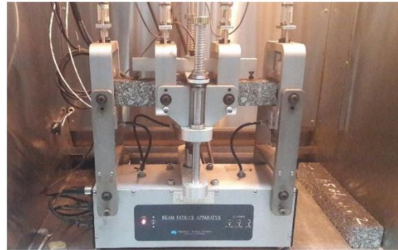
**Gambar 3.** Alat pengujian fatik campuran beraspal menggunakan BFA.
