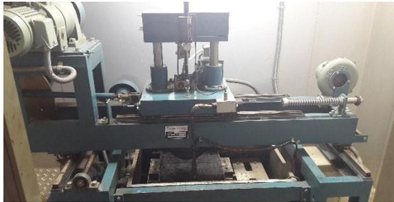
**Gambar 2.** Alat pengujian ketahanan deformasi permanen menggunakan WTM
