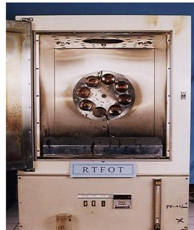
Gambar 1. Alat pengujian *RTFOT*
